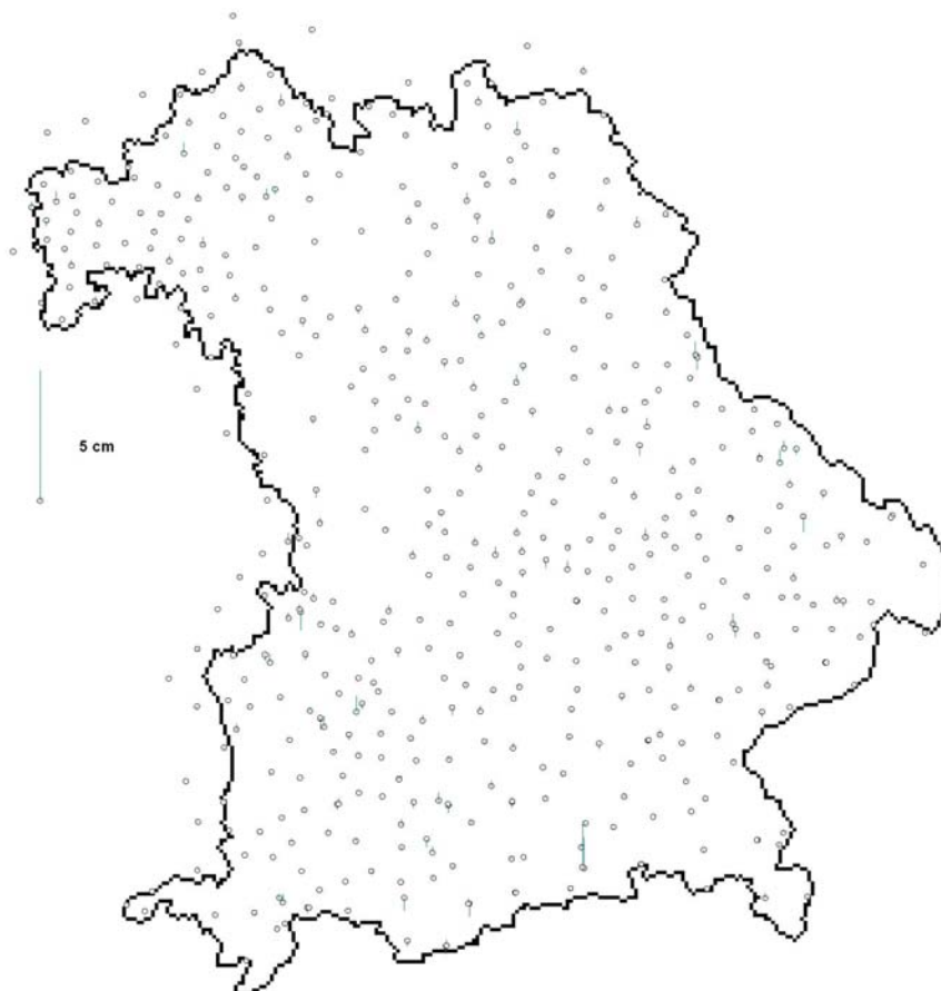
Bild 10: Zur Verbesserung des Geoid-Modells verwendete Stützpunkte mit den Restklaffungen nach der Transformation mit dem Gitter.
