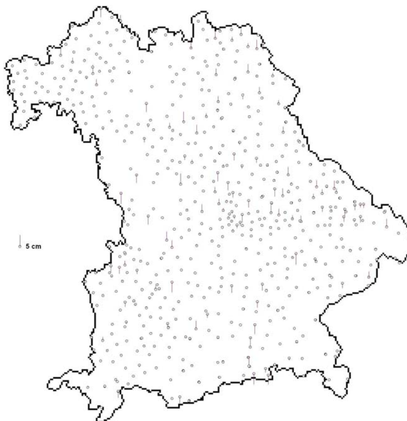
Bild 11: Test des Gitters Version 2005. Nivellierte Höhen minus mit Gitter gerechneten Höhen
