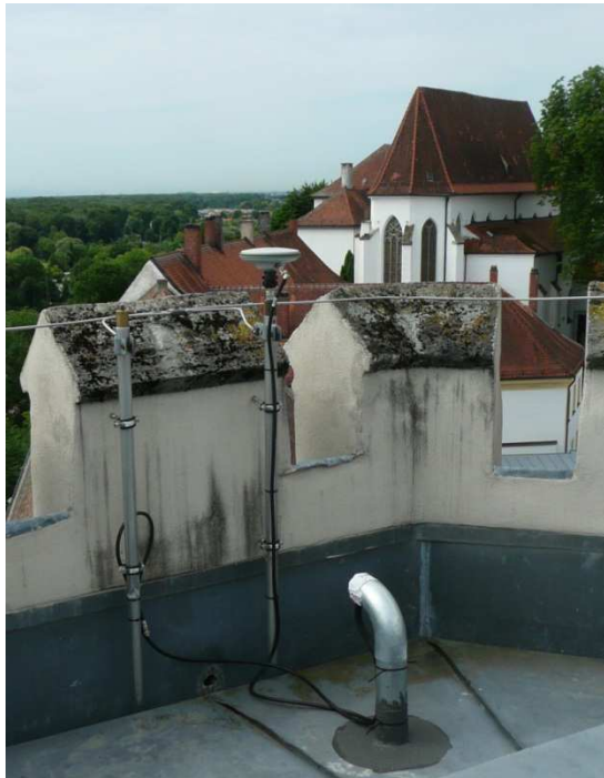
Abbildung 2: GNSS-Roverantenne Leica AS10 an der RTK-Monitorstation Freising. Eine zweite Antennenhalterung dient der Durchführung von Benchmark-Tests.
